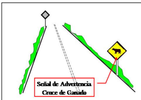
Figura 5.2.1 Plan de Combinación Típica de Instalaciones de Seguridad Vial en Lugares Peligrosos
