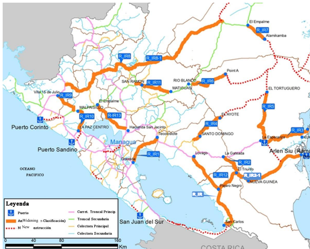
Figura 5.1.4 Carreteras Propuestas para su Rehabilitación
