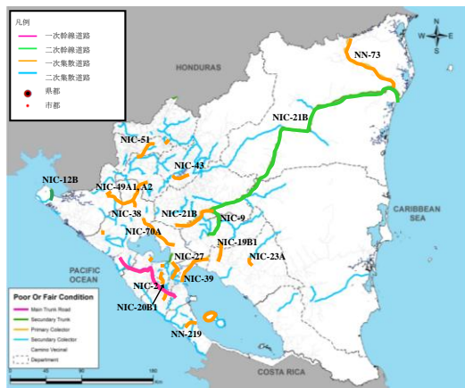
図 8.2.8 優先的 pavement 改修区間
