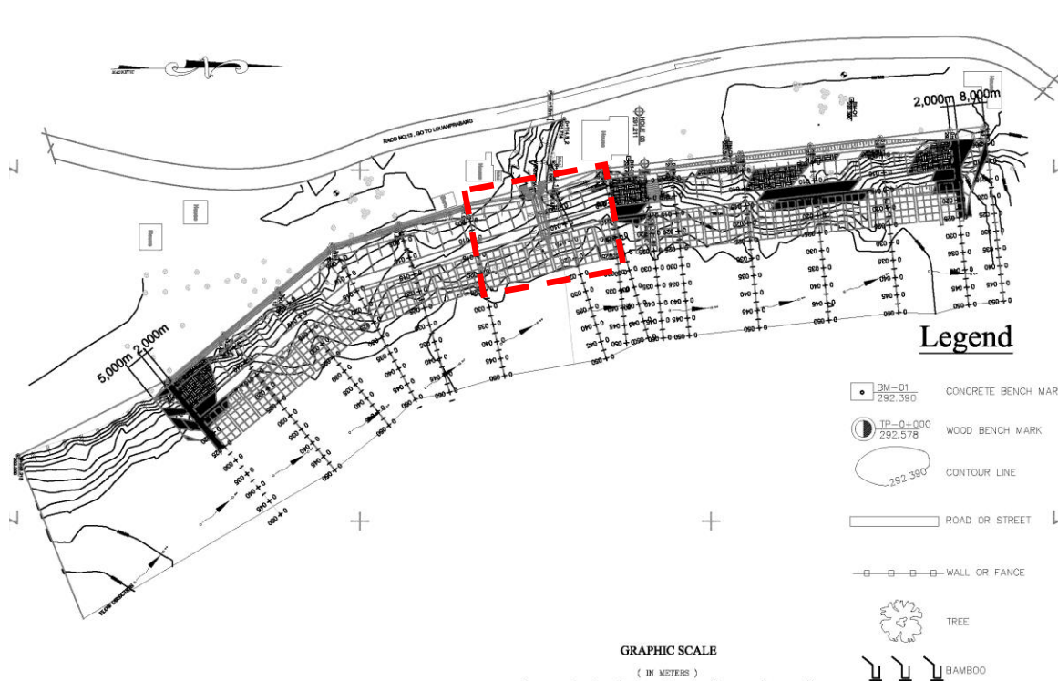
ຮູບ. 3.4-7 ແຜນຜັງ ໂຄງການຕົວແບບກໍ່ສ້າງປ້ອງກັນຕະຝັ່ງ ທີ່ເຂດບ້ານສວນຫຼວງ (ນາສາ) (ໜ້າວຽກເພີ່ມ ຊຶ່ງລວມທັງການກໍ່ສ້າງຢູ່ຈຸດ ລະຫວ່າງ ປາກຮ່ອງນໍ້າ ແລະ ນໍ້າຄານ, ມີຄວາມຍາວທັງໝົດ : 40m)
