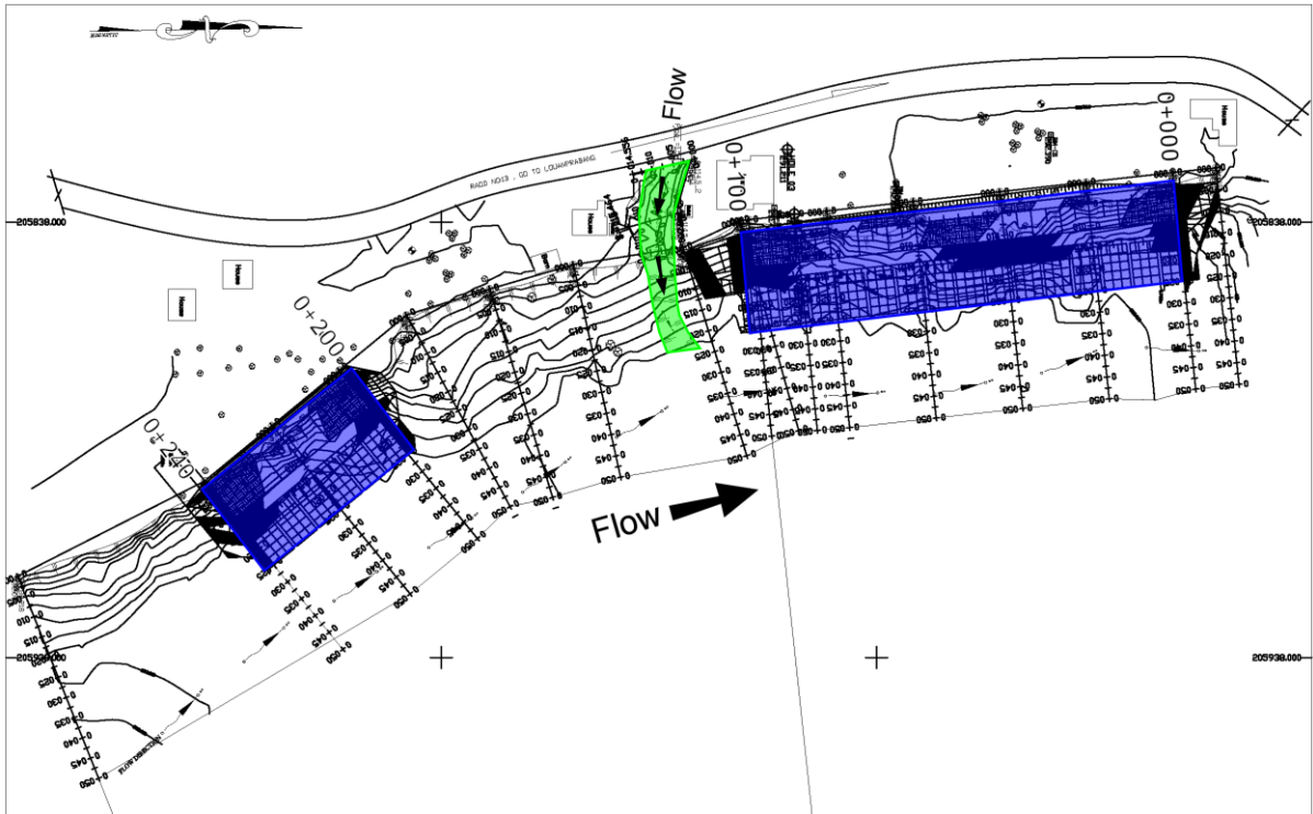
ຮູບ 3.4-4 ແຜກກໍ່ສ້າງຜ້ອງກັຕະຝັ່ງເຈື່ອນ ບ້າສວຫຼວງ (ການອອກແບບຂອງຊ່ຽວຊາໄຈກາ ໃນປີທີ 3, ຄວາມຍາວທັງໝົດ L=140m)
