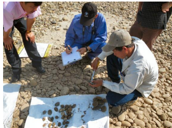
写真 3.3-2 C/P 指導状況(簡易粒度測定)
