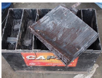
解体されたバッテリー内の鉛極板
