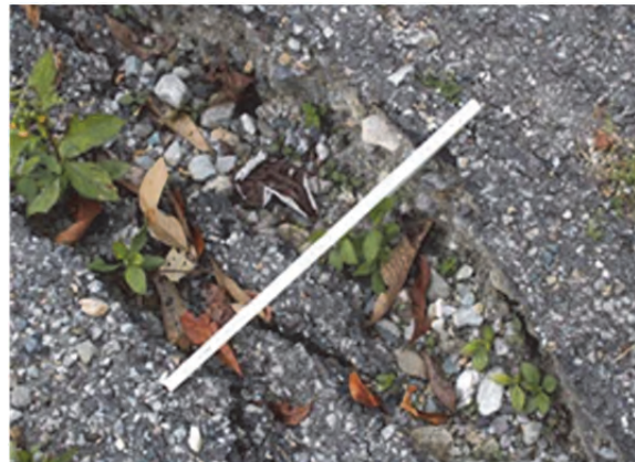
現在の滑落崖(左)と滑落崖の後退を示唆する開口亀裂
