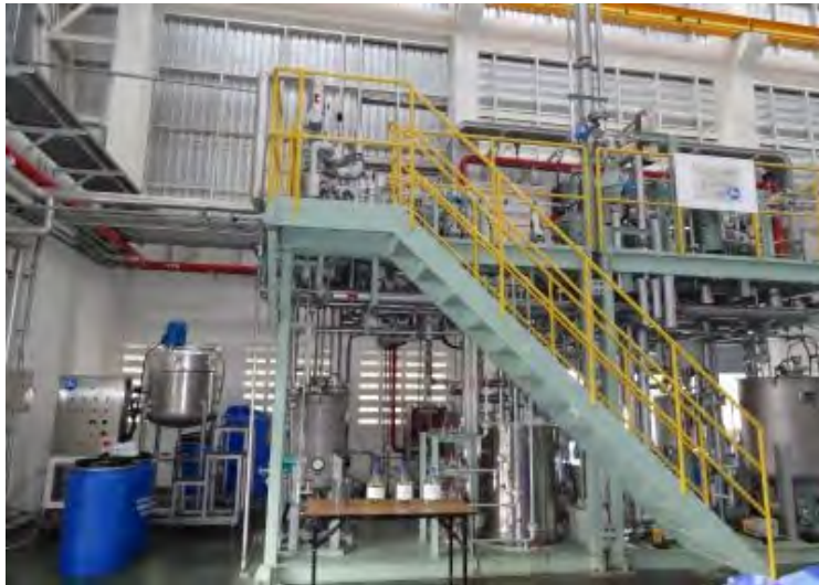
TISTR (科学技術研究院) に設置した BDF (バイオディーゼル燃料) 製造ユニット
