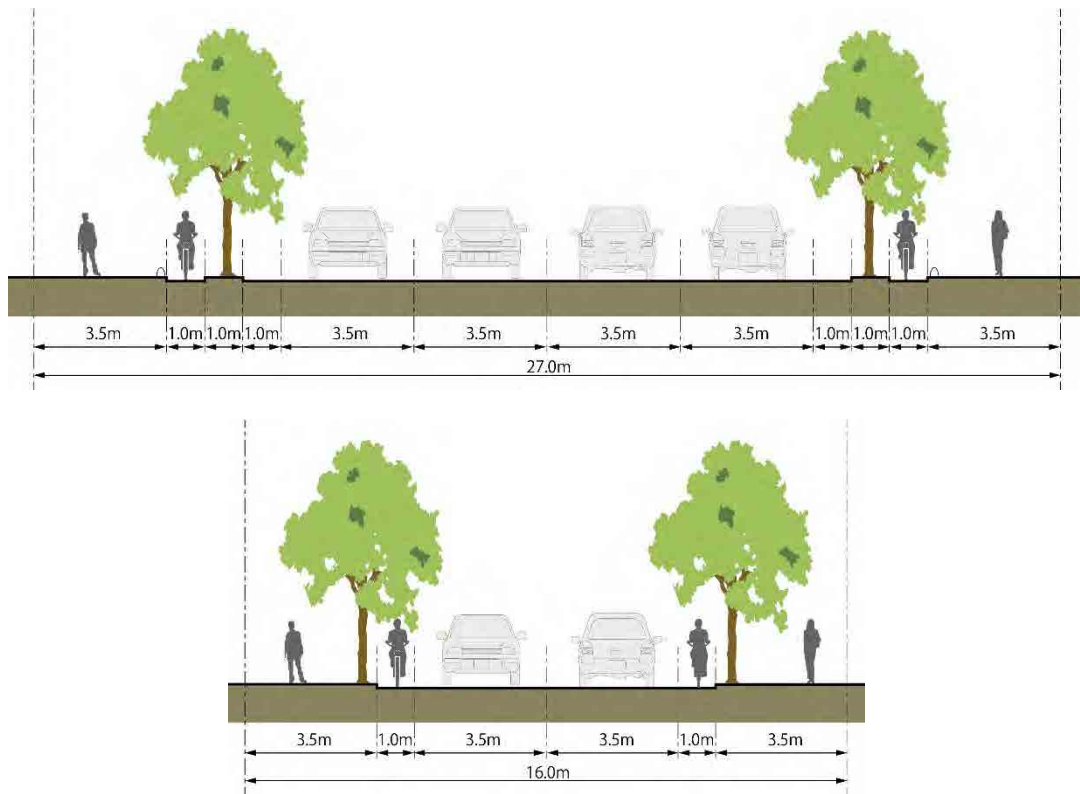
Hình 13.4.13 – Mặt cắt tiêu chuẩn của các tuyến đường mới ở Khu Đại học quốc gia
