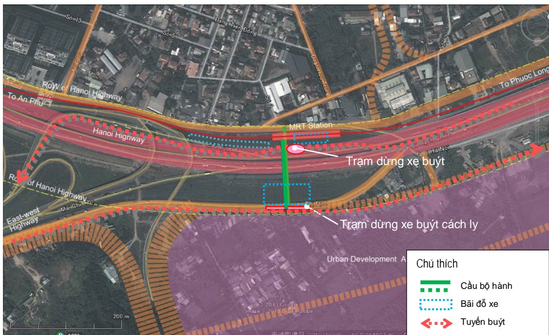
Nguồn: Đoàn nghiên cứu Hình 9.3.17 – Quy hoạch bố trí Khu vực Ga Rạch Chiếc (khi ĐSDT đi vào hoạt động)
