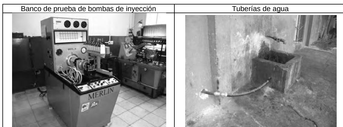
Foto 7-5: Banco de Prueba de Bombas de Inyección
