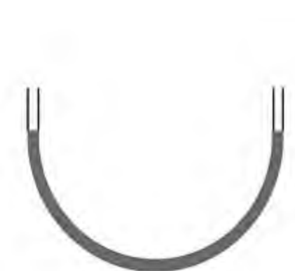
Figura 3-3:Medición del nivel con una manguera de agua
