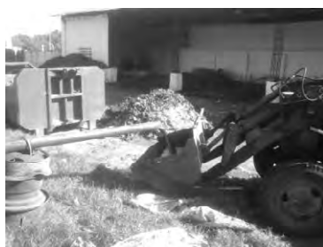
Foto 1-30: El cargador recibe el líquido de fermentación proveniente del tanque de fermentación anaeróbica
