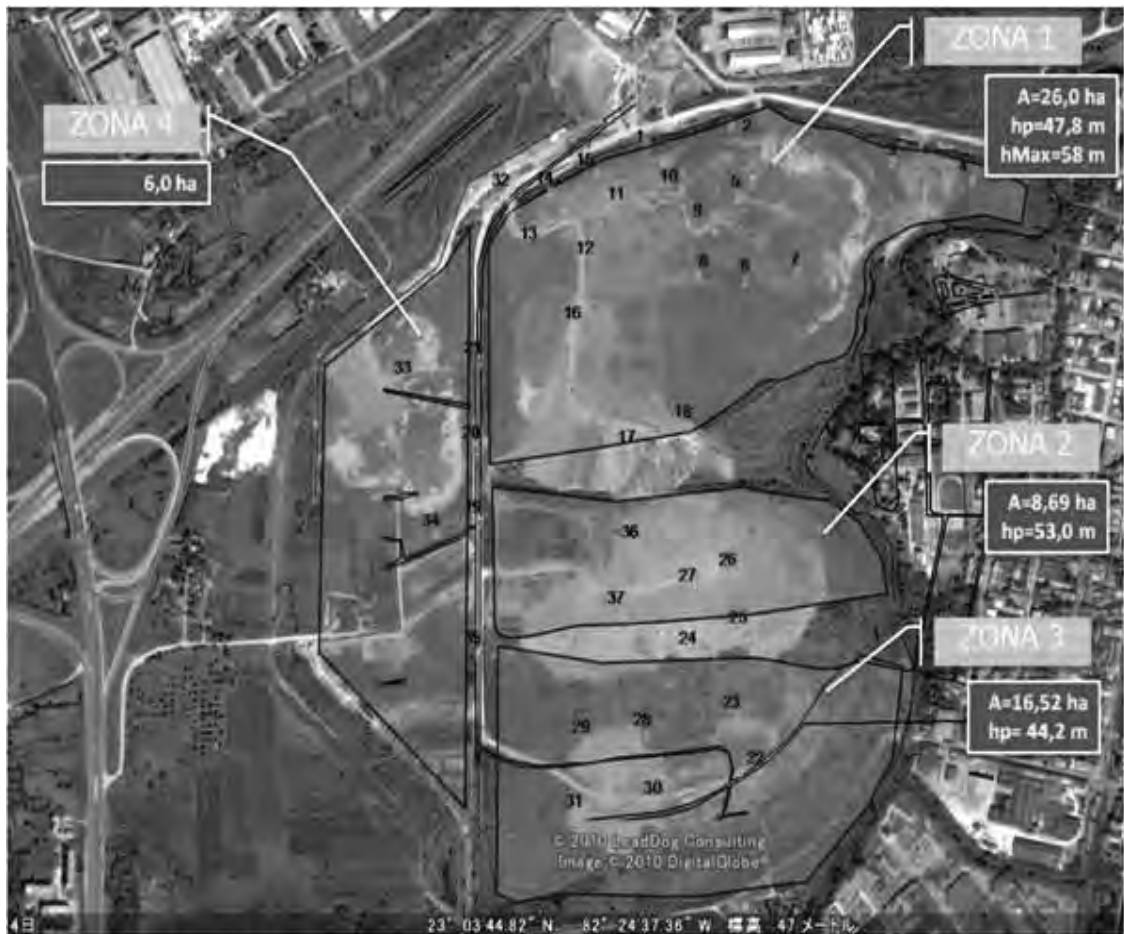
Figura 3-8: Resultado de la medición de las alturas con respecto al nivel del mar con un sencillo GPS
