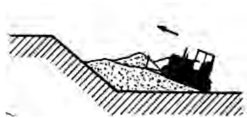
Figura 3-4: Método de empuje de desechos hacia arriba
