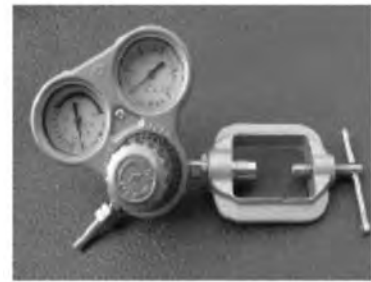
図8 アセチレン用調整器
