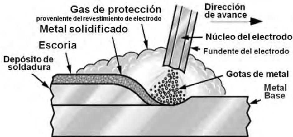
Diagrama esquemático del proceso de soldadura por arco
