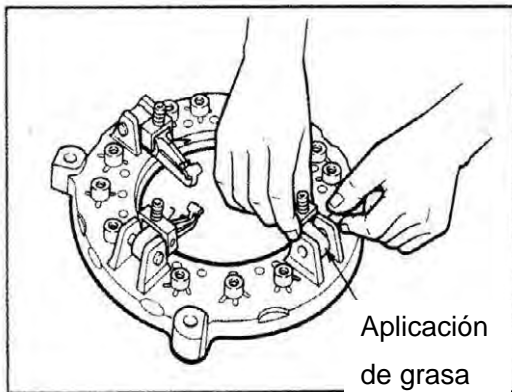
Aplicación de grasa
