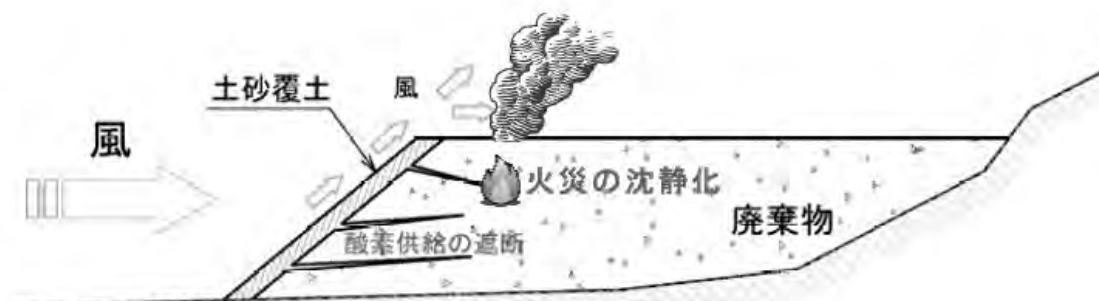
土砂覆土による鎮火対策例
