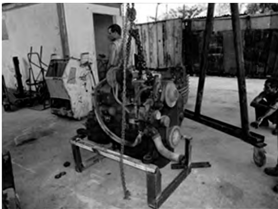
急造の組立て台（エンジンスタンド）
