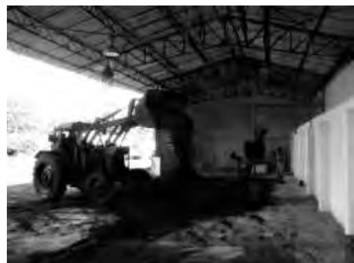
写真 1-40: 壊れた攪拌用機械と既存の重機を利用した攪拌
