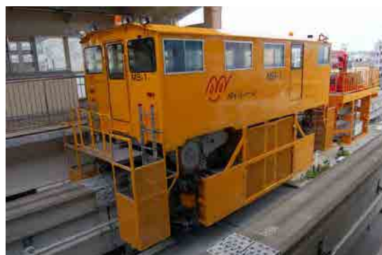
工作車（後方にクレーン車を連結） 沖縄都市モノレール
