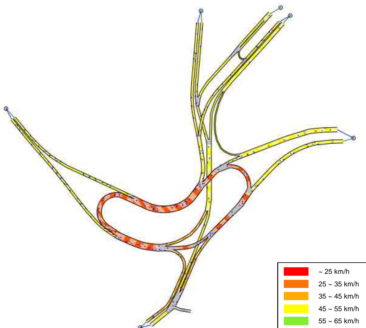
図 11.27 現況ケースにおけるシミュレーション実施結果（走行速度）
