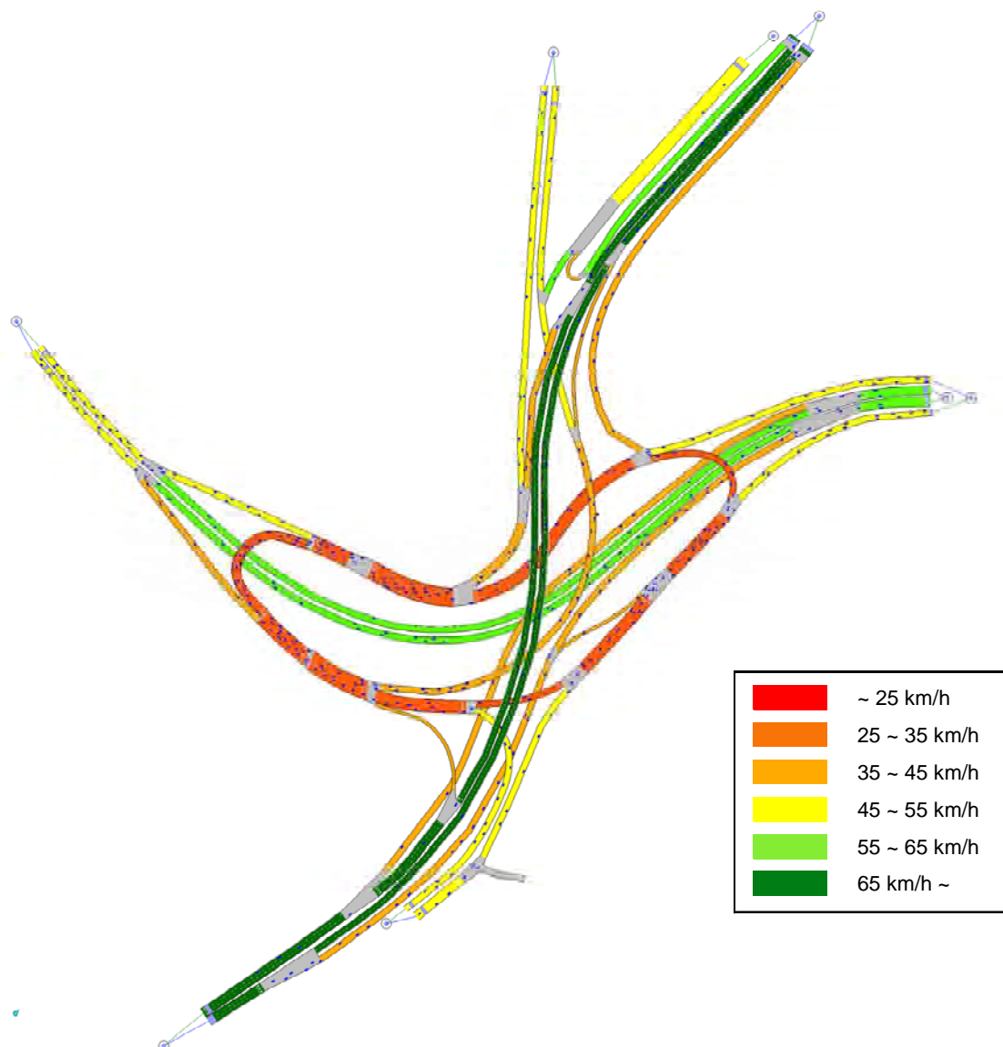
図 11.28 改良案ケースにおけるシミュレーション実施結果（走行速度）
