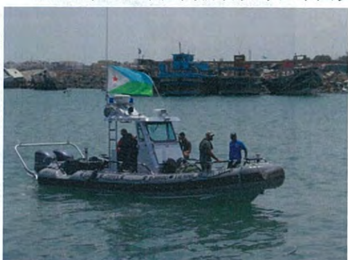
船外機装備アルミ製巡視艇 (全長 9m) (2012 年米国内務省供与。米国製)
