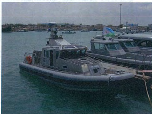
Water-jet アルミ製巡視艇 (全長 11m) (2013 年 9 月米国内務省供与。米国製)
