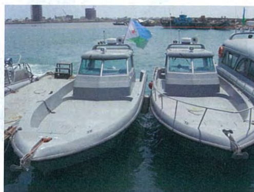
船外機装備 FRP 製巡視艇 (全長 11m) (2013 年 2 月日本資金 IOM 供与。ドバイ製)
