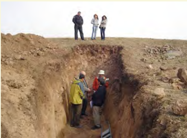
アルメニア地震研究所の研究員に、活断層を調べるためのトレンチ調査の方法を技術移転する
