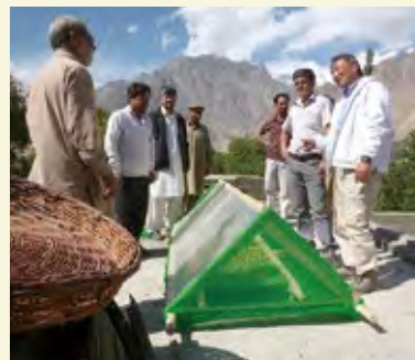
現地の素材を使って試作したアプリコット乾燥機。農家の庭先で、より短時間で衛生的できれいなドライアプリコットができるよう、改良を重ねている
