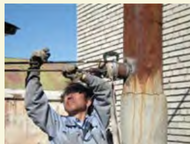
煙突中の排ガス濃度を測定している様子
