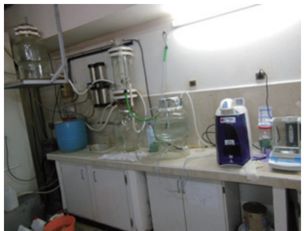
超純水製造装置
