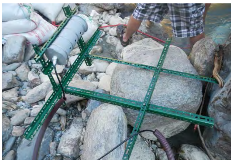
図 1.1 水位計を設置した土台機器
