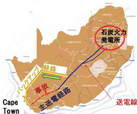
図 3-4-6 送電事故とバックアップ
