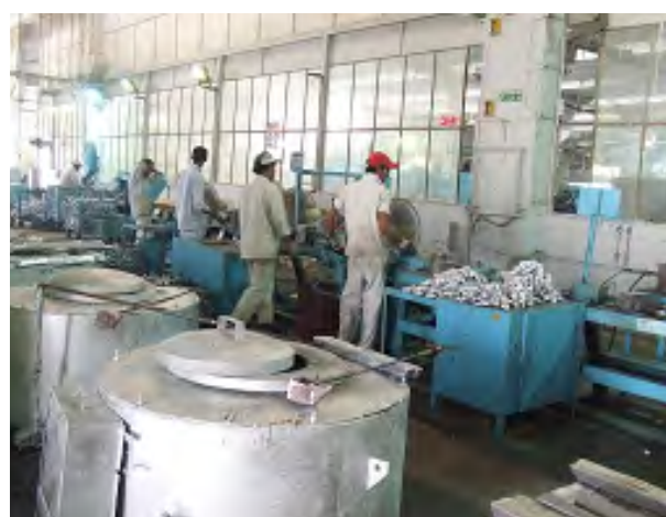
写真11 アルミ鋳物の溶解と重力鋳造工場 鋳型から取り出された製品が山になっている
