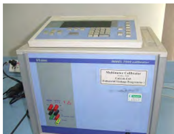
写真 21 PCSIR でマルチメーターの校正に用いられる装置 さまざまな校正機器が揃っている
