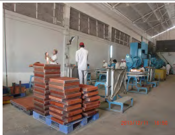
写真 13 自動車部品工場 B の銅製ラジエター 組み立て工場
