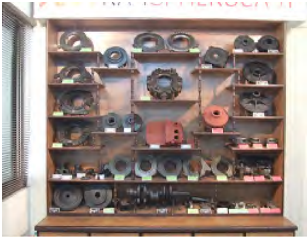
写真 3 鑄造工場 A の製品群 球状黒鉛の製品 が並んでいる
