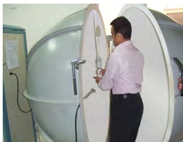
写真 22 PCSIR の電球の分光特性評価装置 積分球で全方向の光を集めて分析する
