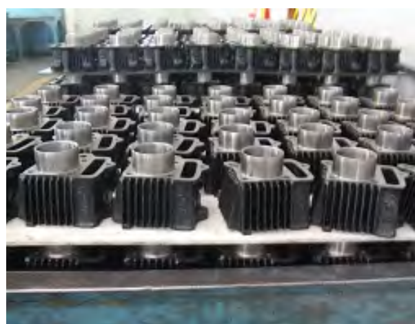
写真12 自動車部品工場 B のアルミ鋳物の機械加工品 小型エンジンのシリンダー
