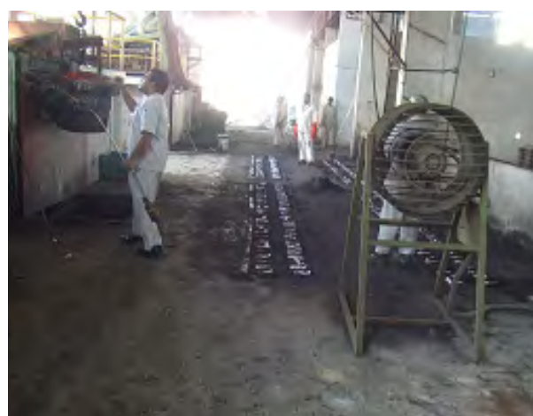
写真10 自動車部品工場 B の鋳造工場 誘導溶解炉と地面に埋め込まれた鋳型
