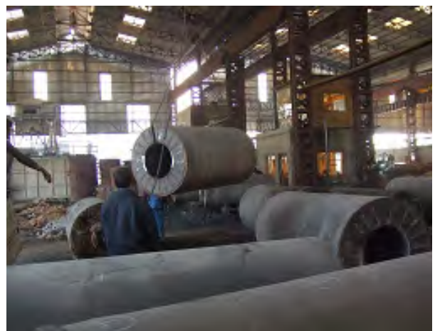
写真 6 鑄造工場 B の鑄造製品 鑄鉄ロール 中心部はグラファイトの中子を用いる
