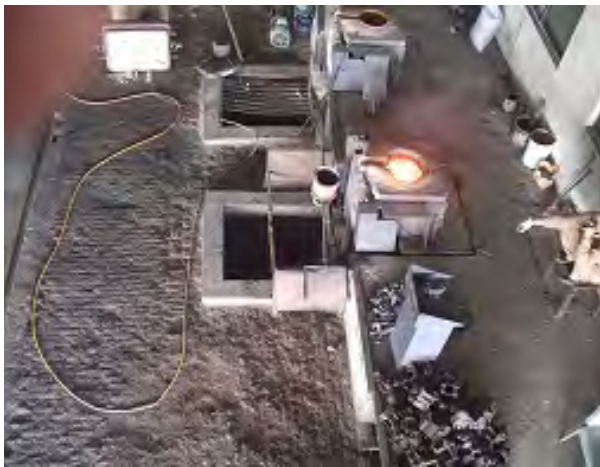
写真 1 鑄造工場 A の鑄鉄の誘導加熱溶解炉 原料には市中から回収した製品を使用
