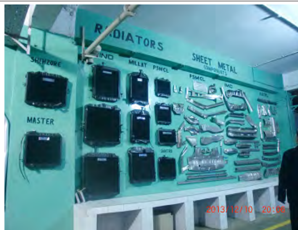
写真7 自動車部品工場 A の製品 プレス成型品とラジエターが展示されている
