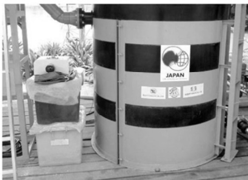
凝集反応タンク：2m 3 、180rpm の攪拌機付き
