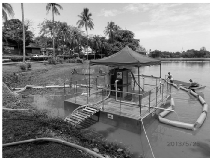
アオコ回収フェンスによるアオコ回収操作の状況
