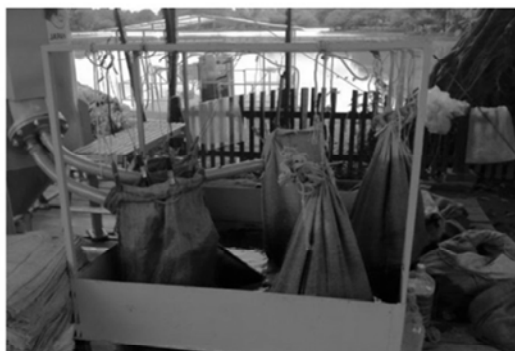
アオコ回収麻袋及びスタンド 麻袋により脱水・回収を行う
