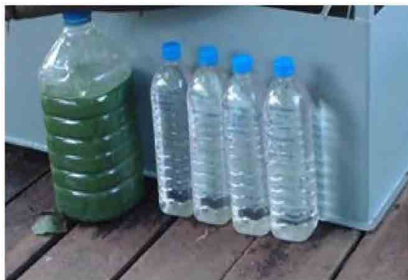
左：処理前の湖水、右：処理後の放流水
