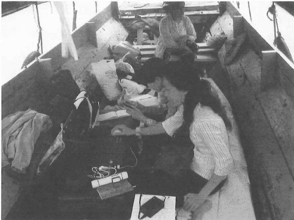
M9 ကိုစက်လှေဖြင့်ဆွဲ၍ ရေစီနှုန်းတိုင်းတာနေစဉ်Laptop ဖြင့် Monitoring ကြည့်ရှုစစ်ဆေးပုံ
