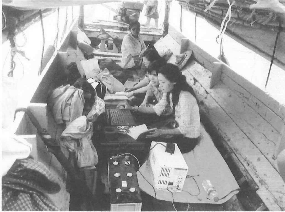
M9 ကိုစက်လှေဖြင့်ဆွဲ၍ ရေစီနှုန်းတိုင်းတာနေစဉ်Laptop ဖြင့် Monitoring ကြည့်ရှုစစ်ဆေးပုံ
