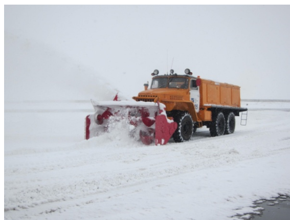
写真-10：集めた雪を路面から芝地に吹くブロワー車。1989 年に配備されたロシア製車両。
