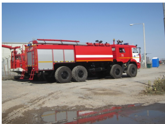
写真-7：空港用消防車 6 台の中の一つ。2010 年に配備されたロシアの KAMAZ 製で、水タンク容量 12,200 L、泡消火剤 800 kg を搭載している。同様な車両がもう 1 台ある。
