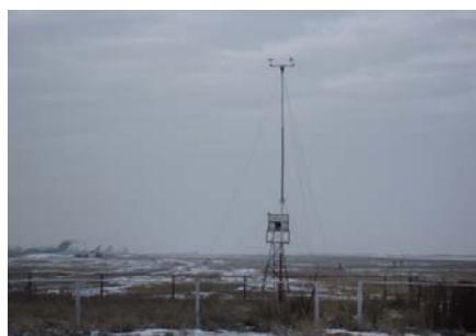
写真 2-1.14 26 側進入用風向風速計
