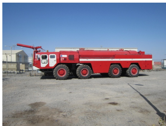
写真-8：空港用消防車 6 台の中の一つ。1983 年に配備されたロシアの MAZ 製で、水タンク容量 12,200 L、泡消火剤 900 kg を搭載している。配備から 30 年経過し、老朽化が著しい。
