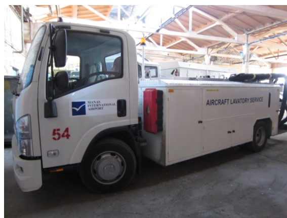
写真-12：航空機からの汚水を運搬するラバトリー車。2013 年に配備された ISUZU のシャーシーにタンクを乗せた車両。
