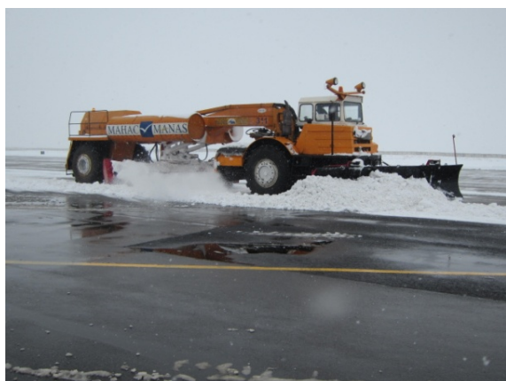
写真-9：路面除雪車で積雪を掻き集める車両。2003 年に配備されたベラルーシ製車両。
