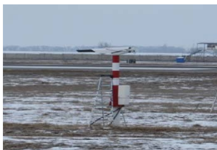
写真 2-1.13 26 側進入用滑走路視距離計
