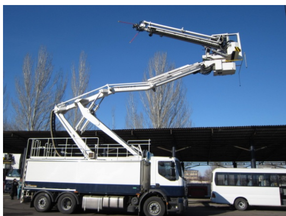
写真-11：航空機の機体に積もった雪に融雪剤を散布する航空機用除雪車。2012 年に配備されたスウェーデン VOLVO 社製の最新鋭車両。
