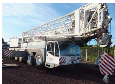
100t トラッククレーン
