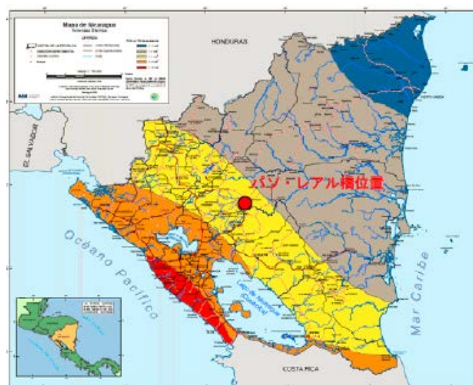
図 3-2.2 「ニ」国における設計水平震度（地表面）
