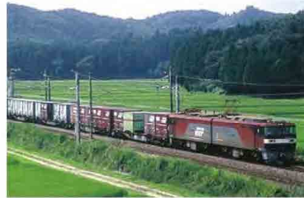
Tàu chở hàng đầu máy chạy điện kéo container (Nhật Bản) Tốc độ vận hành tối đa 110km/h
