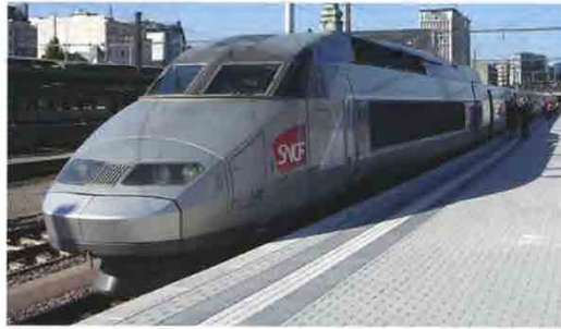
Tàu sử dụng PCS (hệ thống tập trung động lực) (Pháp, TGV-R)
