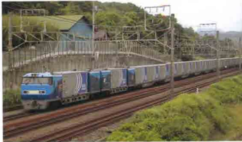
Tàu chở hàng sử dụng hệ thống EMU đầu tiên trên thế giới (ở Nhật Bản tên gọi phổ biến là “SUPER RAIL CARGO”) Tốc độ vận hành tối đa 130km/h
