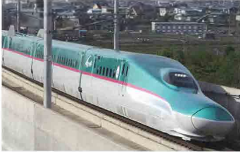
Tàu sử dụng EMU (hệ thống động lực phân tán) (Nhật Bản, Tohoku Shinkansen loại E5)
