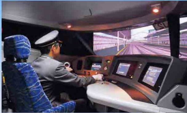
Đào tạo lái tàu có sử dụng hệ thống mô phỏng
