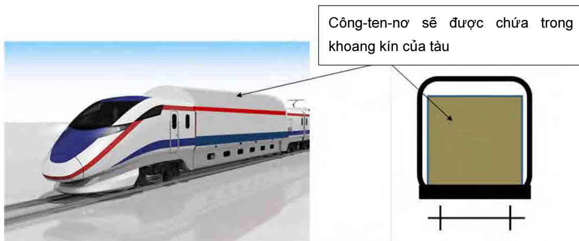
Hình 5.2.4 Hình ảnh minh họa toa xe hàng hóa container tốc độ cao Body Mounted
