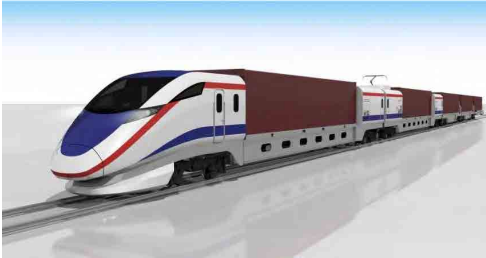
Hình 5.2.1 Hình minh họa toa xe hàng hóa container tốc độ cao
