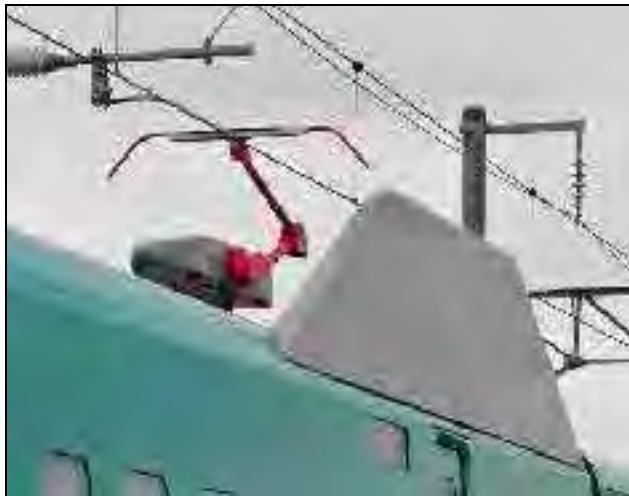
Hình 5.3.39 Cần lấy điện ít tiếng ồn và các tấm chắn giảm ồn
