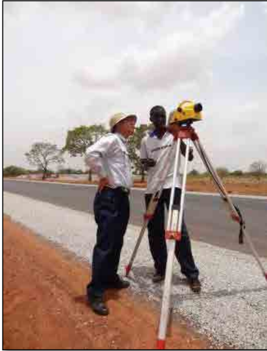
Encadrement sur l'opération de nivellement par les membres de l'équipe d'étude
