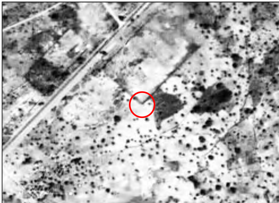
Photo 2-7 Position d'un point piqué sur une image ALOS (GCP-49)
