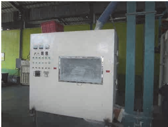
廃基板の破砕機
