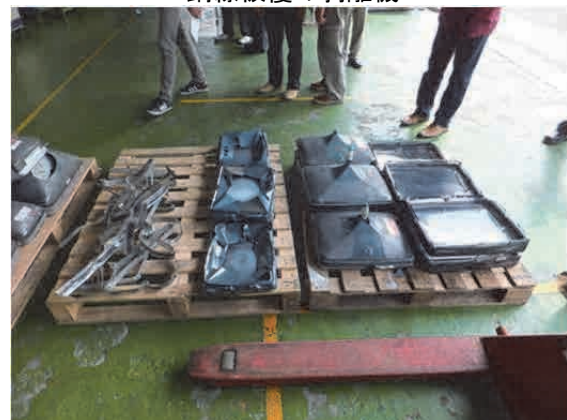
解体後のブラウン管テレビ （鉄・プラ等は現地でリサイクルされる）
