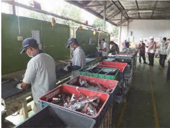
PC・サーバーなどの手解体の状況 (廃基板が取り外される)
