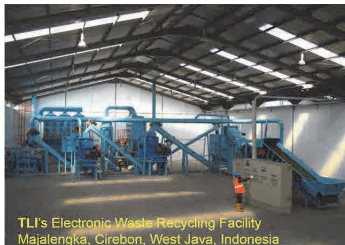
TLI 社が導入したプリント基板の破碎・選別機
