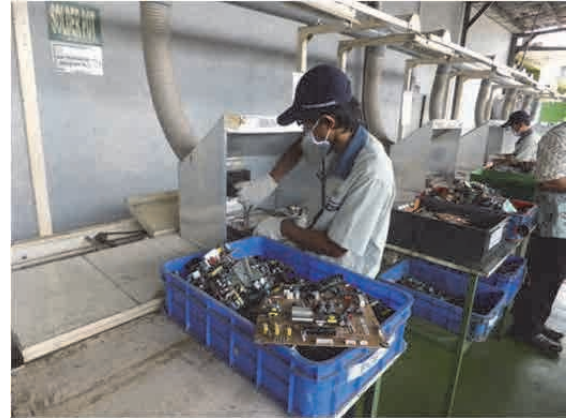
加熱により基板のはんだを溶かして 部品を回収する様子
