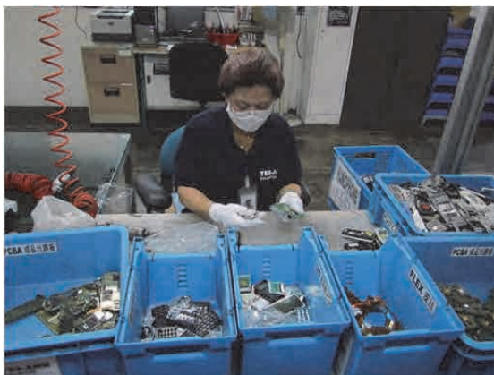
解体・分別作業中の作業員
