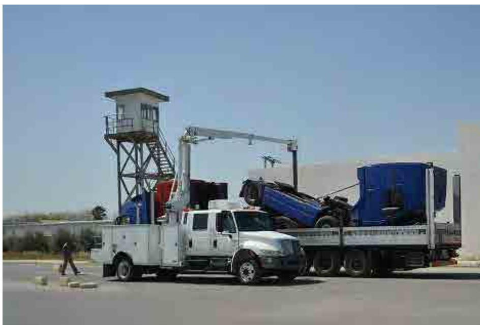
図 4.2-6 SHB 貨物トラックターミナル内で運用されているモバイル型スキャナー
