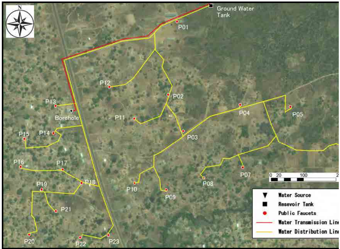
図 3-8 ムウエンセ郡 Kapakala 給水施設全体配置計画
