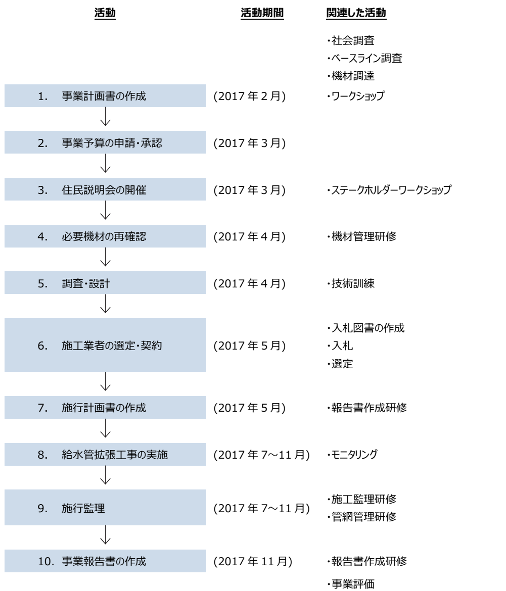
図-7.3 業務実施フロー（給水管拡張工事）
