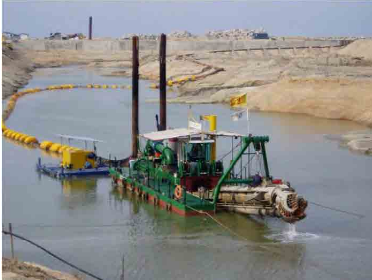
Figura C.37 Foto de una draga de succión con cabezal cortador (Fuente: "IHC Beaver Cutter Suction Dredger" International Marine Consultancy)
