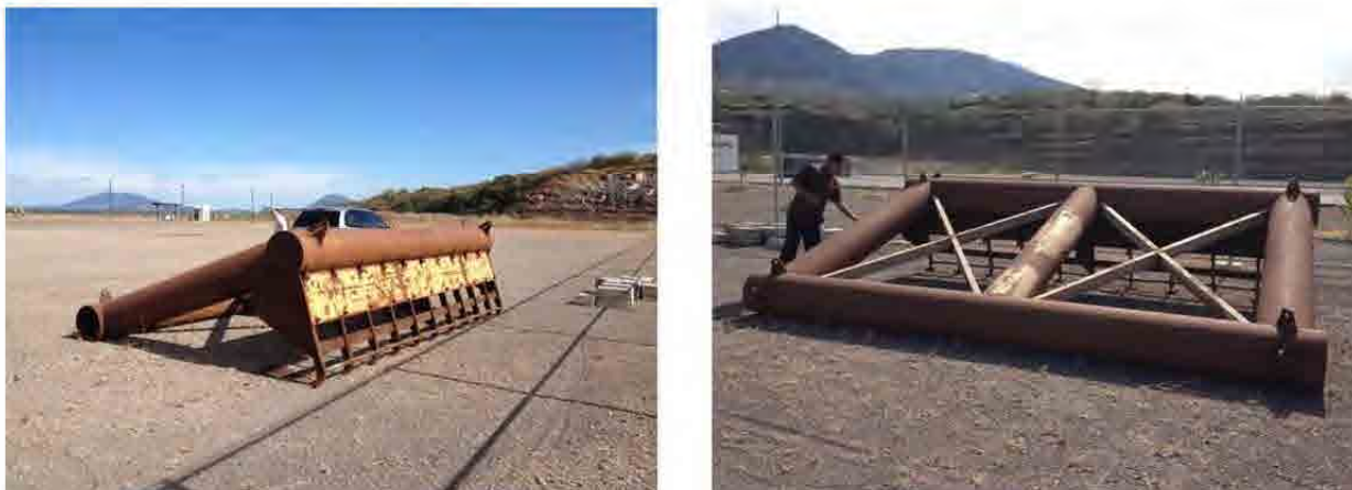
Figura C.12 Fotos del rastrillo utilizado en el dragado
