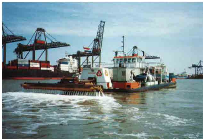
Figura C.18 Barco de WID (Fuente: PIANC Report No. 120-2013 DRAGADO POR INYECCIÓN (J. Smith et al. 2013))
