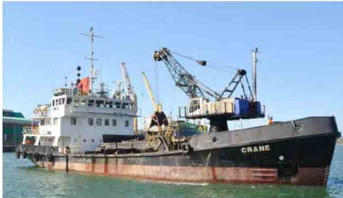
(a) Fuente: “Draga de cuchara CRANE” Axeonalias, RC Groups.com
