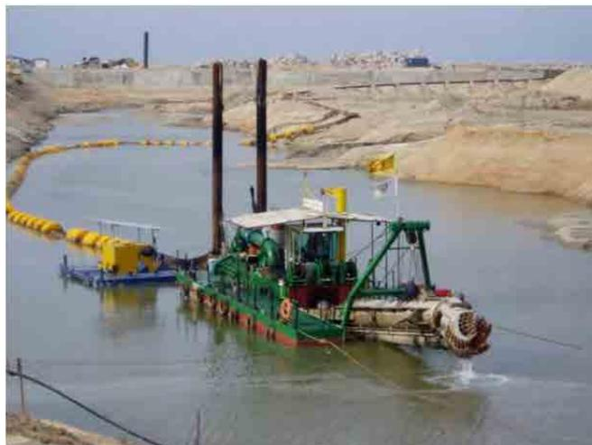
Foto 5.1 Draga de succión con cabezal cortador
