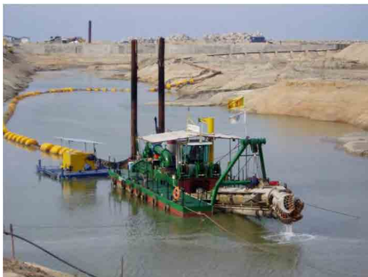
図 C.37 カッターサクシオン浚渫船の写真 (出典: “IHC Beaver Cutter Suction Dredger” International Marine Consultancy)
