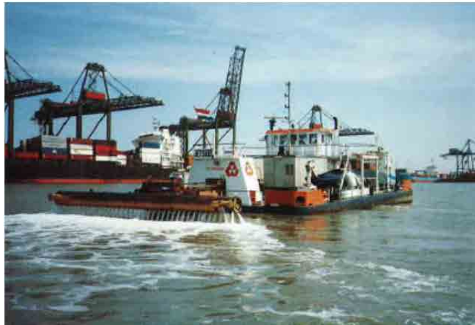
図 C.18 WID 浚渫船 (出典: PIANC Report No. 120-2013 INJECTION DREDGING (J. Smith et al. 2013))
