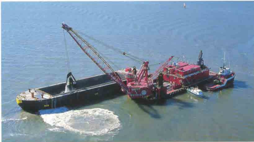
図 C.43 グラブホッパー浚渫船の写真と概念図
