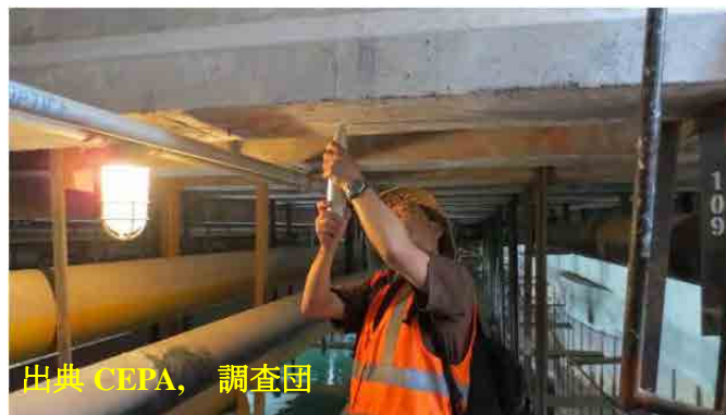
図 8.18 A 岸壁上部工のスラブにおけるシュミットハンマー・テストの向き
