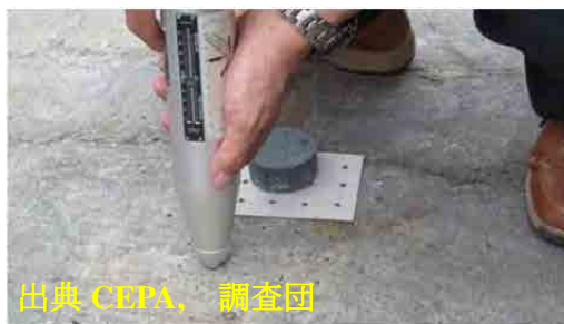
図 8.19 B 岸壁上部工でのシュミットハンマー・テストの向き
