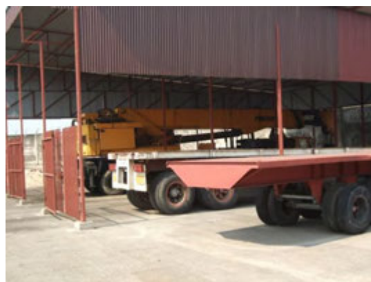
写真 2-2 75 トントラッククレーン
