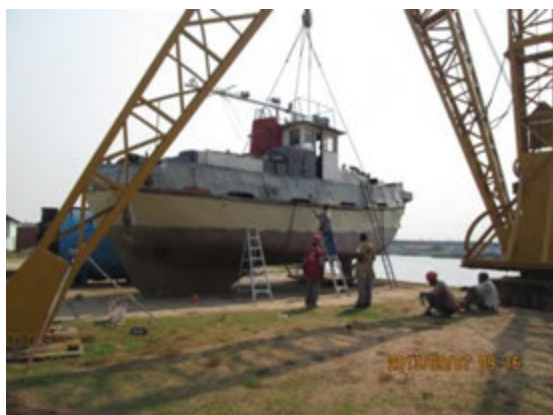
写真 2-1 既設クレーンにて タグボート上架
