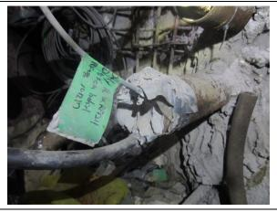
モルタルにより岩盤深くに埋設された 観測機器(Cooke4 鉱山)
