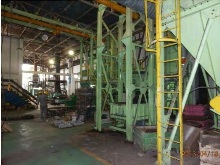
MIDC の設備③（自硬性鑄型造型設備）
