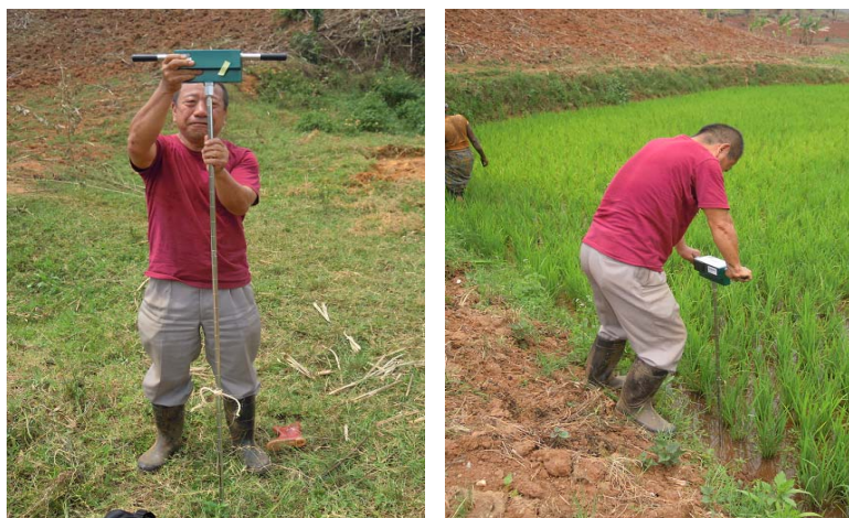
Etat d'épreuve de la pénétration du cône
