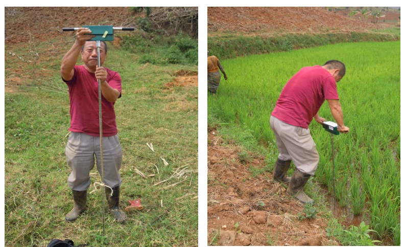
コーン貫入試験実施状況
