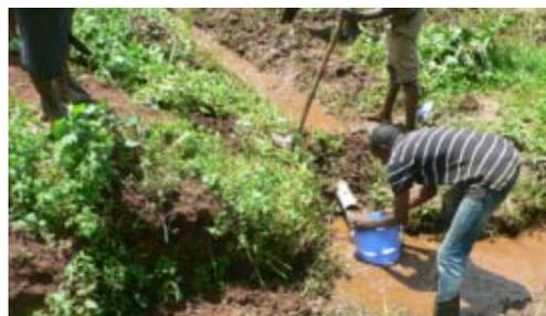
試験状況： 流れの脇の既存迂回小水路を整備し転流させるとともに、堰上げ壁に埋設したパイプで流量を測定。現況流量  $Q=1.29\ell/\text{sec}$
