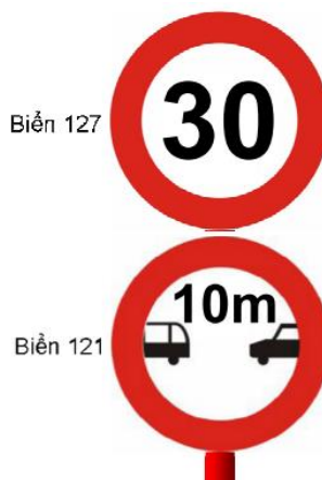
Hình 4.4 Biển báo khống chế tốc độ tối đa và cự ly tối thiểu giữa hai xe
