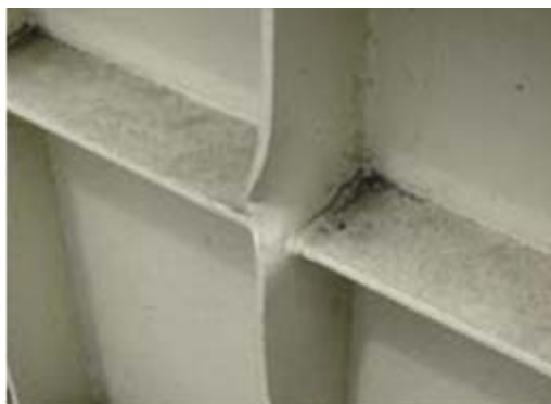
H23.1 Biến dạng cục bộ với sườn tăng cường đứng
