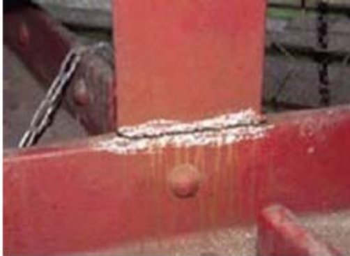
H21.5 Âm thanh từ phần đứt gãy của mối hàn liên kết giữa thanh giằng và thanh treo
