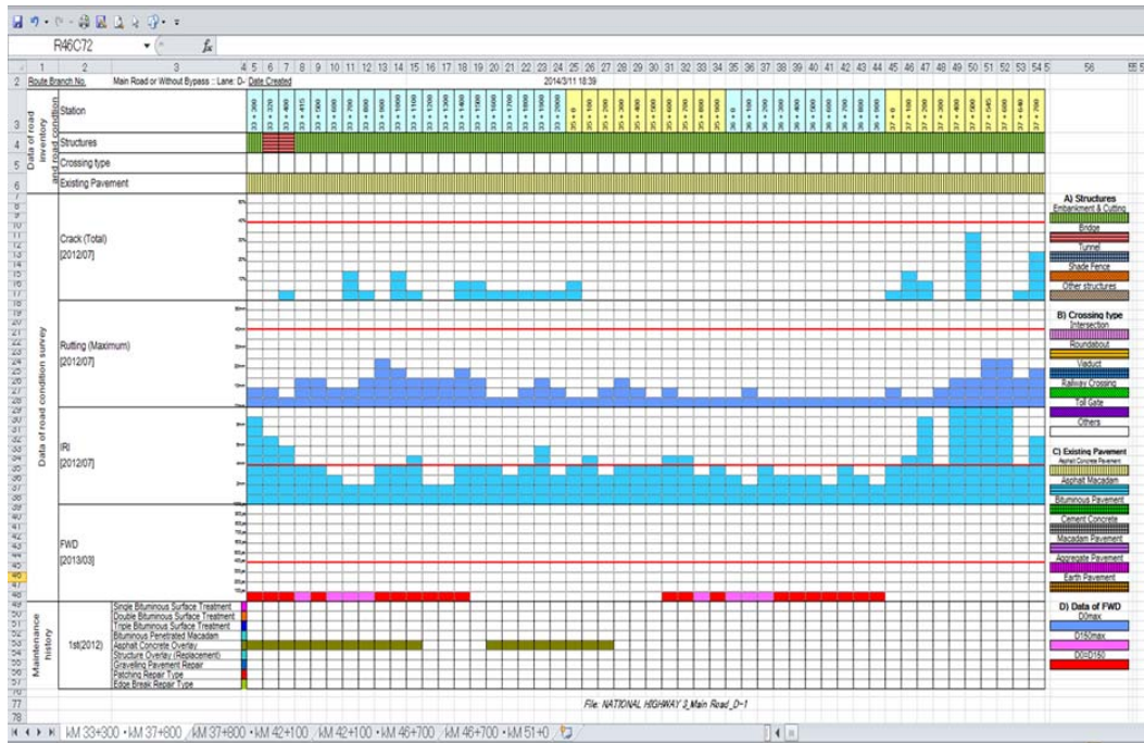
Hình 3.11 Hệ thống theo dõi tình trạng mặt đường (PMoS)
