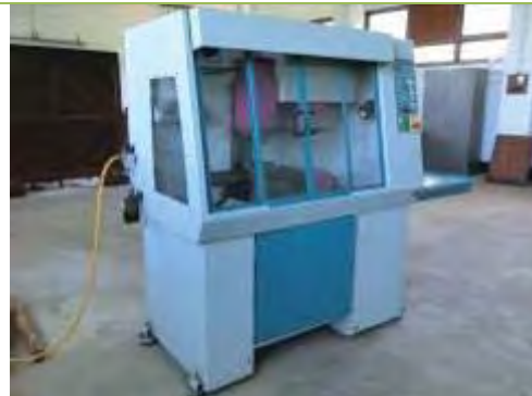
写真-6：ヤンゴン工科大学 機械工学科の既存機材。2000 年英国製のマシニングセンタ。2008 年のサイクロンで浸水・故障。
