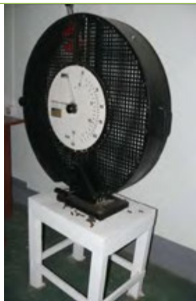
写真-11：マンダレー工科大学既存機材（機械学科）。ドイツメーカーの衝撃試験機。目盛が壊れているがマニュアルがなく、修理の仕方がわからないので使用されていない。
