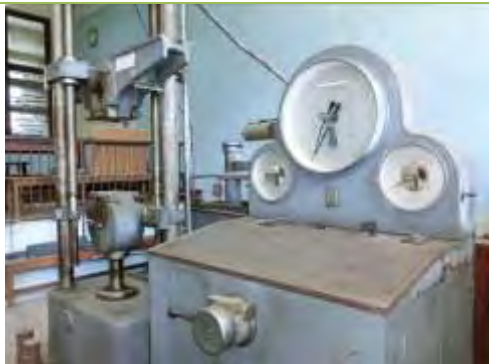
写真-5：ヤンゴン工科大学 機械工学科の既存機材。1958 年旧ソ連製の 50t 万能試験機。故障のため使用不可。
