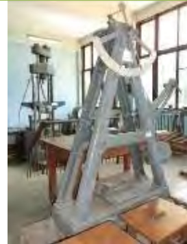
写真-2：ヤンゴン工科大学 機械工学科の既存機材。120ft-lb アイゾット衝撃試験機。試験片固定装置（アンビル）が紛失しており運転不能。
