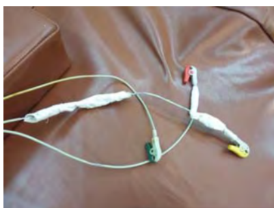
手術室にある患者監視装置 使用頻度の高い装置は特に患者装着部に強い傷みが見受けられ、更新が必要である。
