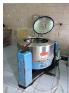
ランドリー室にある脱水機 経年劣化により機械式ブレーキが故障し、修理不可能な状態になっている。
