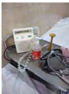
外来にあるドップラー胎児診断装置 プローブの不良が発生して診療活動に支障がある。
